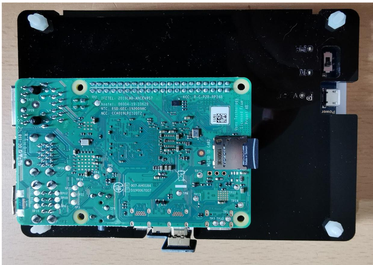
**Displayrückseite mit aufgestecktem Raspberry Pi 4**
