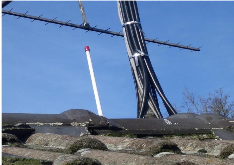
Als Antenne beim Tracker ist ein Stäbchen als Antenne dabei. Das Stäbchen spielt auf 460MHz. Also auf jeden Fall nachmessen und wie auch beim C5, mit Schrumpfschlauch die Resonanzfrequenz herunterziehen. So auf dem Armaturenbrett, geht es aus dem Fahrzeug gut 2-3 Km weit.
