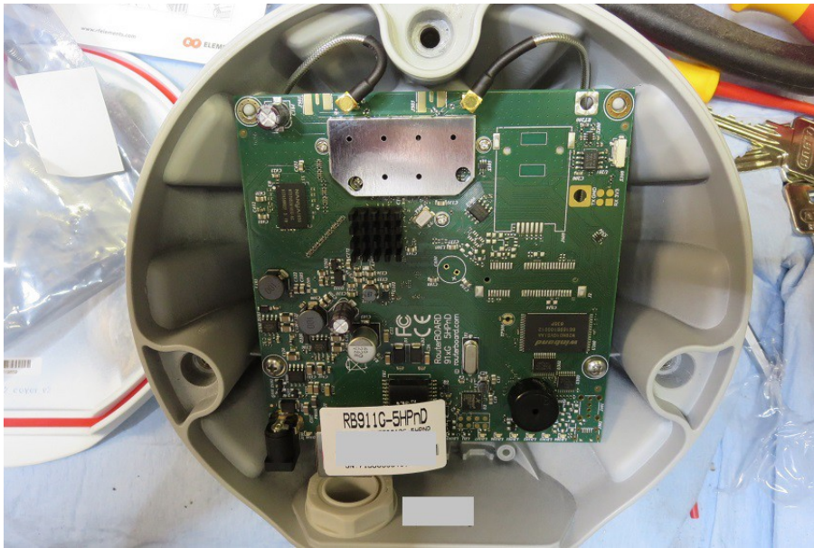
Montiertes Routerboard in das Adaptergehäuse
