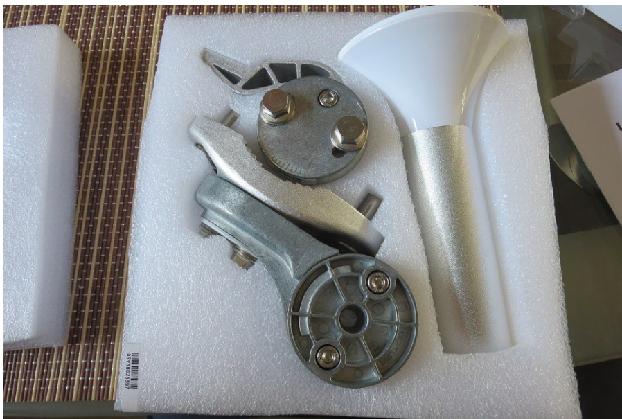
Cassegrain - Erreger und Teile der Masthalterung
