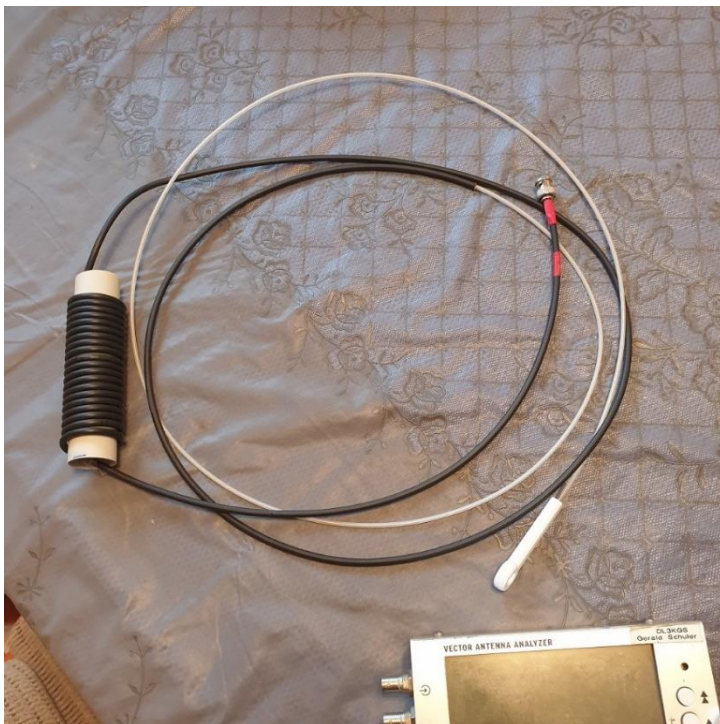
Abb. 5: Fertige Antenne jedoch für niedrigere Frequenz und mit kurzem Speisekabel
