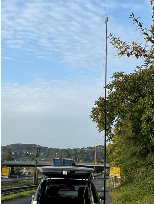
**Bild der Client-Station (DO1VN) in Bad Hönningen. Am GFK-Mast ist die Client-Station befestigt**
