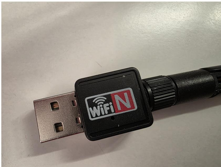
Die „Wifi“ Antenne ist eine Externe USB betriebene um die Reichweite zu erhöhen.
