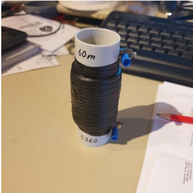
Bild 10: Offener 60m Sperrkreis mit selbstschweißendem Band umwickelt
