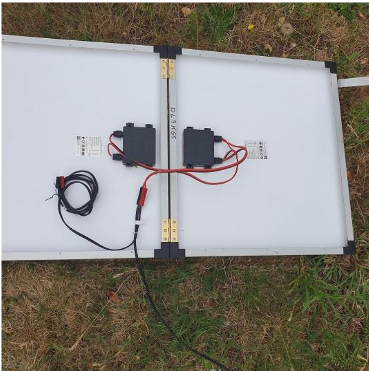
Mechanische und elektrische Zusammenschaltung der Module
