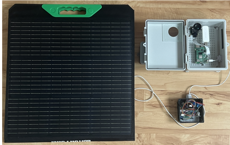
Abbildung 14: Überwachungseinheit mit Gehäusebohrungen für Kamera und Kabeldurchführungen
