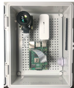
Abbildung 9: Raspberry Pi, Kamera und 4G Dongle
