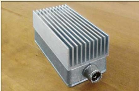
Zum Funktionstest eines Senders oder im Rahmen einer Reparatur ist ein geeigneter 50-Ω-Ersatzlastwiderstand anstelle der Antenne unverzichtbar. Er gehört daher in jedes Shack. Wie hier gezeigt, ist der Selbstbau eines qualitativ guten Dummy-Loads mit überschaubarem Aufwand möglich.
