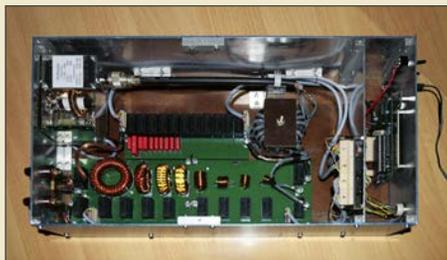
Der Selbstbau eines KW-Antennenkopplers ist ein anspruchsvolles Projekt, das auch für erfahrene Funkamateure eine Herausforderung darstellt. Als Beispiel dafür kann der hier beschriebene, fernsteuerbare Koppler PicATU500 gelten. Dieser ist für Sendeleistungen bis 750 W ausgelegt und ermöglicht komfortablen Automatikbetrieb auf der Basis gespeicherter Abstimmdaten. Foto: DL4JAL
