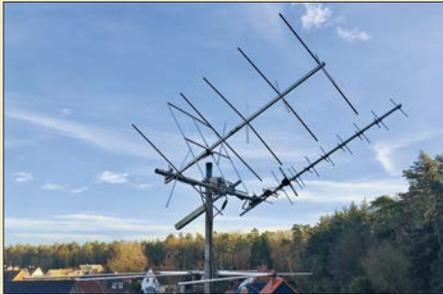
Dreheinrichtungen mit Azimut- und Elevationsrotor dienen beim Funkbetrieb über umlaufende Satelliten zum manuellen oder automatischen Nachführen der Richtantennen. Die hier beschriebene Anlage besteht aus instandgesetzten Kenpro-Rotoren, dem kommerziellen Steuergerät ARS-USB von Pablo Garcia, EA4TX, sowie einer selbst gebauten Stromversorgung. Foto: DK1OM
