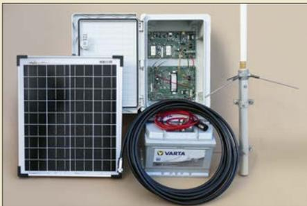
Eine transportable, einfach zu installierende FM-Relaisfunkstation mit autarker Stromversorgung kann beim Notfunkbetrieb helfen, auch über größere Entfernungen stabile Verbindungen herzustellen. Zu diesem Zweck wurde der vorgestellte Bausatz-Repeater entwickelt. Dieser ist auch als gemeinschaftliches Bastelprojekt gut geeignet und kann dazu beitragen, das Thema Notfunk in den Fokus zu rücken. Foto: Red. FA
