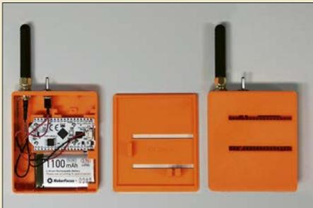
Die Entwicklung von LoRa-Anwendungsschaltungen und -software ist um vieles einfacher, wenn eine geeignete Testumgebung zur Verfügung steht. Das hier beschriebene Gerät auf Basis eines Heltec-Boards ist via Bluetooth und USB bedienbar. Es kann Punkt-zu-Punkt-Verbindungen herstellen und Funkabdeckungen überprüfen. Foto: DL2MEE
