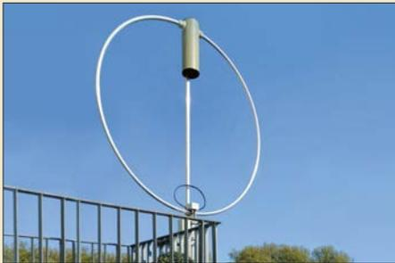
Am Beispiel einer kommerziell gefertigten Magnetantenne mit Koppelschleife wird in diesem Beitrag gezeigt, wie sich die prinzipbedingte frequenzabhängige Fehlanpassung nahezu eliminieren lässt. Die entwickelte Anpassungsschaltung ist auch an Eigenbautantennen verwendbar. Foto: DK3BA
