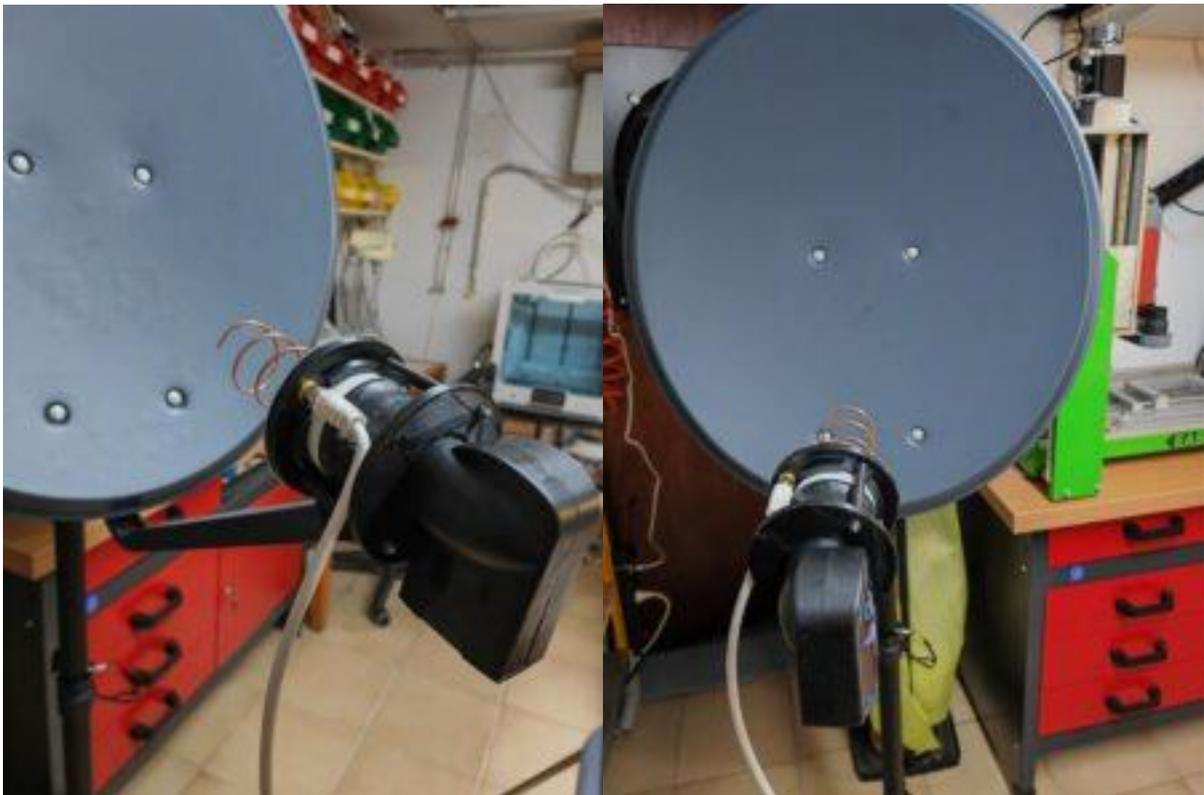
In der Thingiverse Datei ist auch ein Excel-File, das hilft, die Helixantenne richtig und gut positioniert auf den Spiegel zu schrauben.
