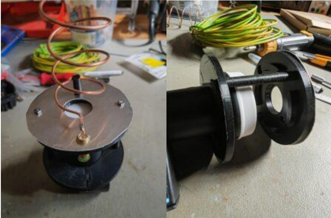
Für den Anschluss habe ich einen Anschluss für Satantennen gewählt. Da der Abgleich über den Abstand des Anschlusses zum Reflektor stattfindet, ist dies eine einfache Möglichkeit, das leicht umzusetzen, weil die an das Blech gelötete Seele sich leicht in der Buchse bewegen lässt.
