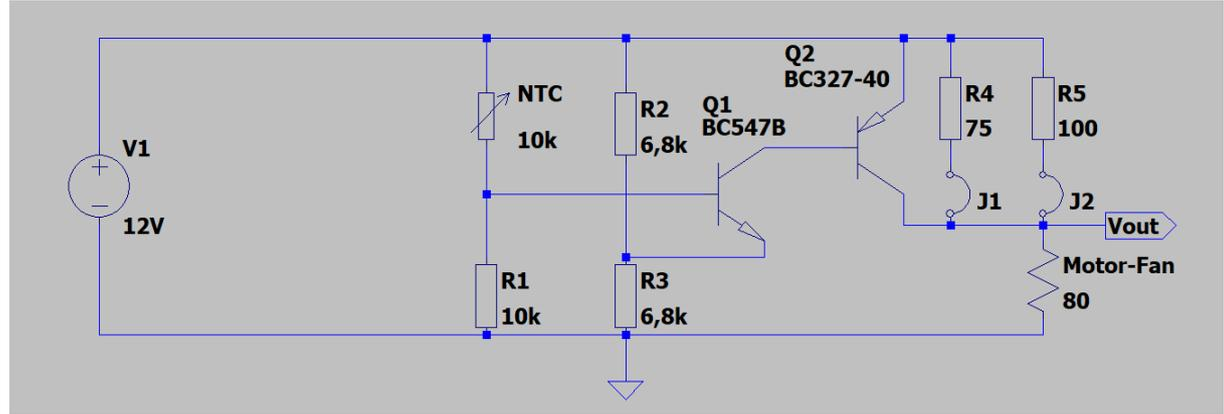
Der „Ruhestrom“ für langsamen Lauf wird von den 1W Widerständen R4 und/oder R5 als Vorwiderstand mit Hilfe von J1 und/oder J2 ausgewählt.
