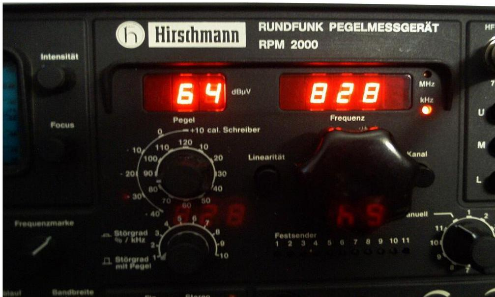
Bild 4 Hier ein Störsignal, das über eine Antenne aufgenommen wurde und mit dem Rundfunk-Pegelmessgerät gemessen worden ist.
