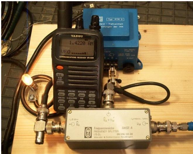
Anschluss für Spektrum Analyzer oder Oszilloskope
