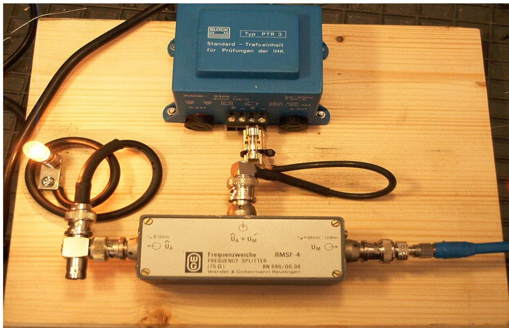
Dazu wird ein Trafo benutzt der die 230Volt auf 15Volt transformiert. Die Weiche trennt den Niederfrequenten Bereich <100Hz von dem >80kHz bis 12MHz. Das ist erforderlich, weil die Beeinträchtigungen im Mittelwellbereich auftreten und diese dann dadurch getrennt von den 50Hz gemessen werden können.
