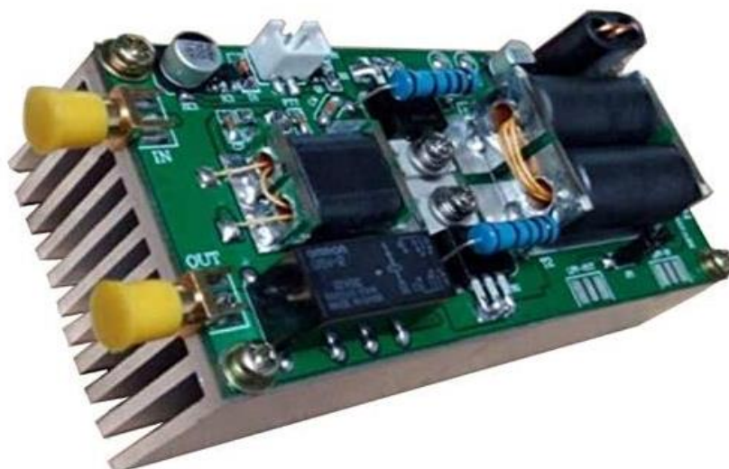
Die rein symmetrischen Endstufen ohne jegliche Selektionsmittel
