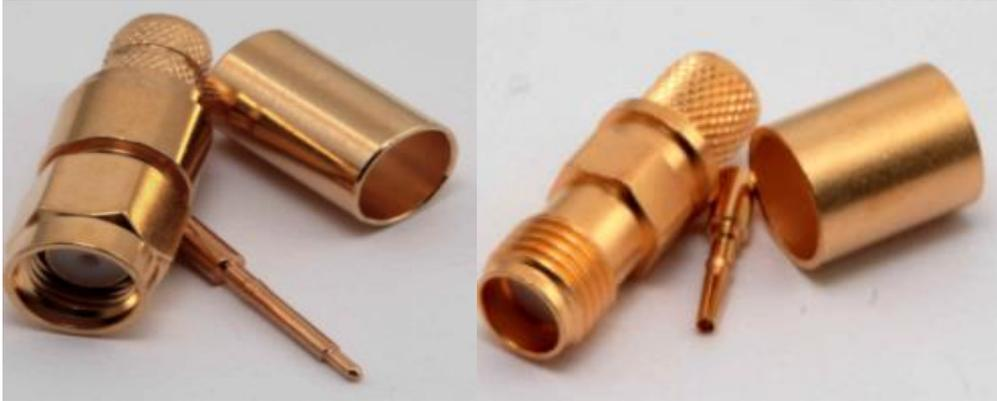
Die Serie SMA umfasst koaxiale Steckverbindungen mit Schraubverschluss. Sie können je nach Standard Ausführung bis zu einer Frequenz von 18GHz eingesetzt werden. Der Wellenwiderstand beträgt  $50 \Omega$  und das empfohlene Kupplungsdrehmoment ist 79-113Ncm und die Schlüsselweite beträgt 8 mm. SMA-Steckverbindungen werden im Mobilfunk, Satelliten und der Messtechnik eingesetzt.
