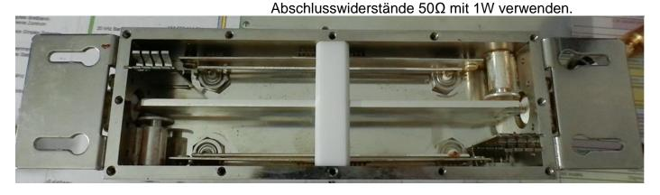
Die Durchgangsmessung man achte auf den geringen S 21 Dämpfungsverlauf! 0,03dB
