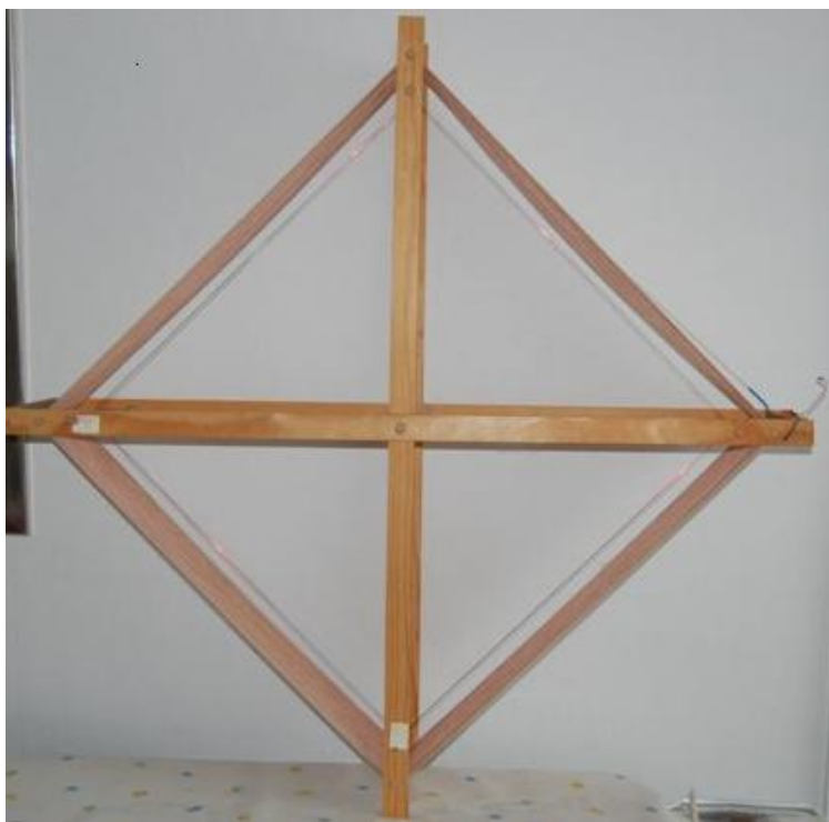
Seitenansicht einer ähnlichen Antenne ohne Abstimmittel zur Veranschaulichung des Aufbaues hier in Holzausführung.
