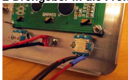
**Verbinde einen PIN des Save-Tasters mit dem Mittel-PIN des Memo-Drehgebers.**
