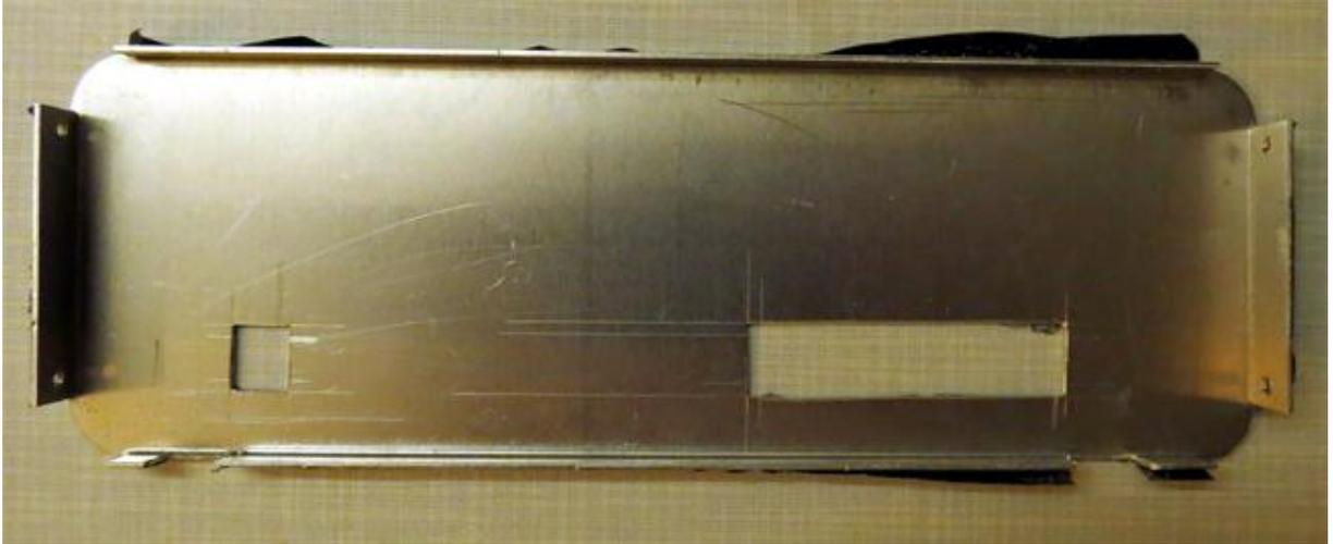
3. Schraube die 1. Distanzhülse auf der Displayseite der Platine ab, drücke die Platine in die Aussparung der Rückwand und sichere mit einer Zwinde, bohre mit 3 mm ein Loch in die Gehäuseschale, entgrate die Bohrung und befestige wieder die 1. Distanzhülse an der Platine.
