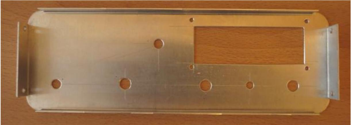
3. **Stecke die 4 Schrauben M2,5 x 16 mm und die 5 mm Kunststoff-Distanzrollen in die Frontwand ein.**
