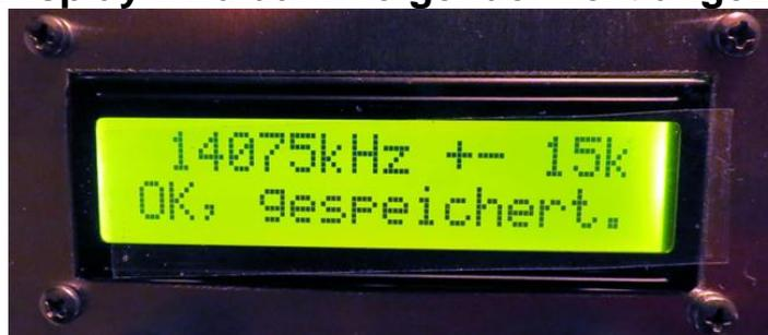
Mit dem Memo-Drehgeber kannst Du dir den Inhalt der Speicher anzeigen lassen bzw. mit Tastendruck als neue geänderte Einstellung speichern.
