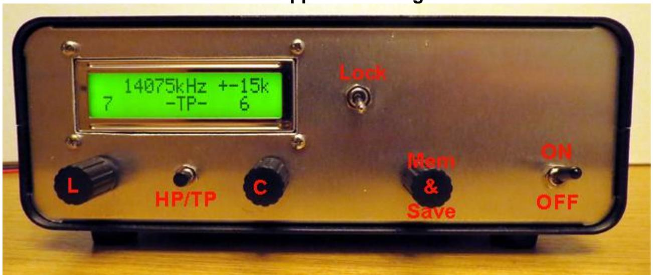
Die Einstellungen veränderst Du mit den Drehgebern für L und/oder C und/oder Du tastest HP/TP. Die neue Einstellung speichere mit einem Tastendruck auf den Memo-Drehgeber.
