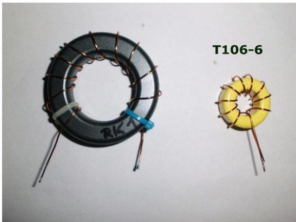
Möglich ist auch eine Doppelschleife aus einer Paralleldrahtleitung, beispielsweise ergeben 215 cm Zweidrahtleitung einen Schleifendurchmesser von ca. 68cm (willkürliche Länge gewählt), d.h. die Gesamtlänge der Schleife beträgt 430cm und hat eine Induktivität von  $8\ \mu\text{H}$  (gemessen). Mit dem T106-6 ergibt sich folgender Frequenzbereich: ca. 5,5MHz bis 26MHz und mit dem RK1 von sind die Bänder 80m/40m und 30m zu realisieren (ca. 3 MHz bis 13MHz).
