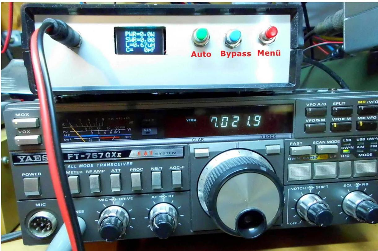
Das Gehäuse hat 2 Stromversorgungsbuchsen eine vorne und eine hinten damit man flexibler verkabeln kann. Weiterer Nutzen ist das Durchschleifen der Versorgung an andere 12V Kleinverbraucher. (Tipp von OE1IAH (2))
