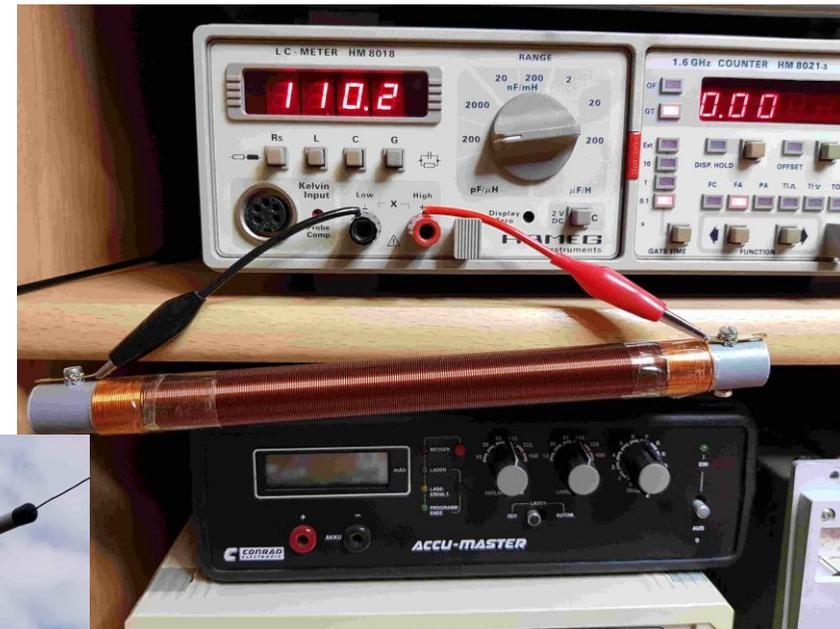
Durch Materialien vom örtlichen Baumarkt fügte DG9OBO die 80m-Verlängerungsspule wetterfest in das Antennensystem ein:
