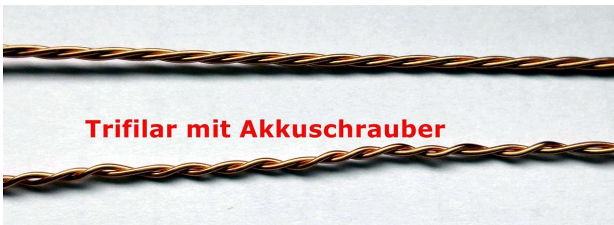
(die unteren Drähte sind per Hand gewickelt, die trifilare Wicklung mit Hilfe eines Akkuschraubers)
