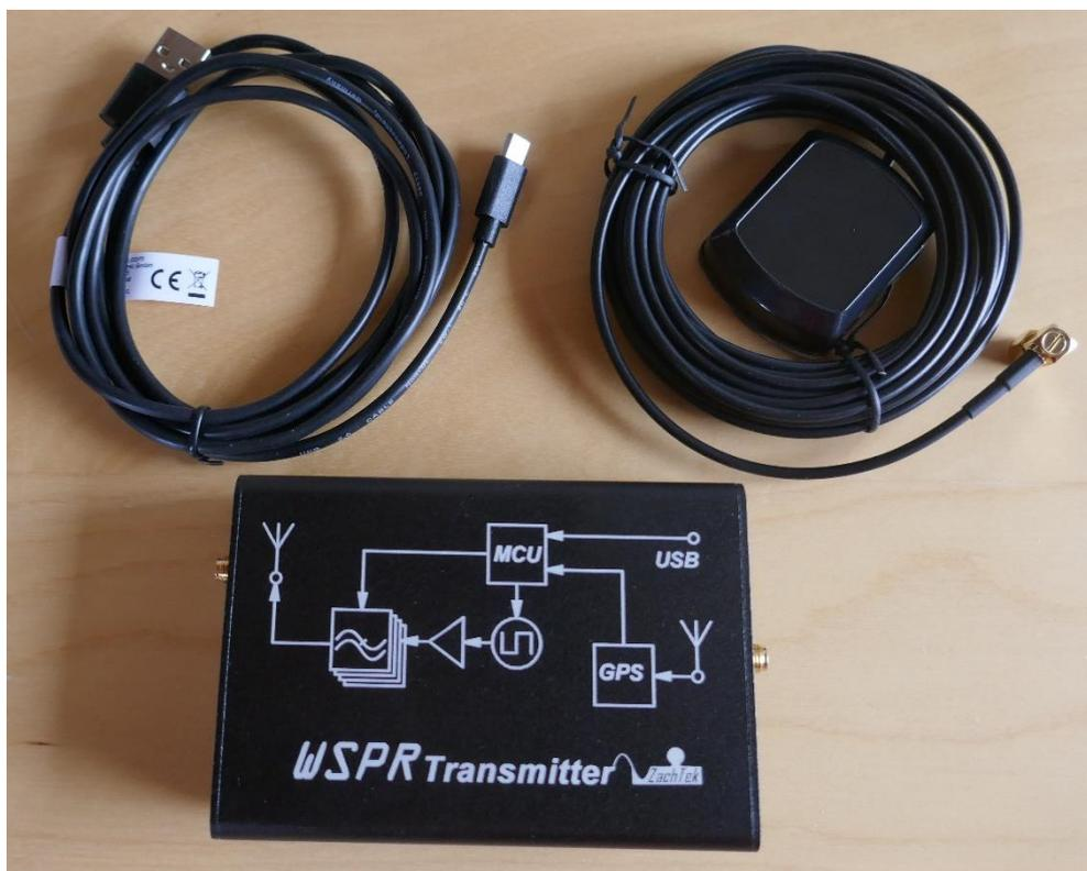
*Inhalt des Paketes mit der WSPR-Bake: Ein persönliches Anschreiben lag dem WSPR-Modul bei, ebenso ein USB-Kabel und die GPS-Antenne mit einem 3 m langen Kabel. Lediglich ein passender Adapter für die SMA-Buchse muss man noch besorgen.*
