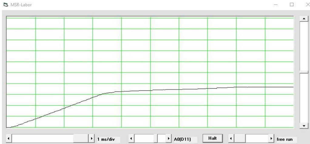
Weiteres Beispiel: Übertragungskennlinie eines Transistors in Emitterschaltung (Darstellung mit negativer Rampenfunktion)
