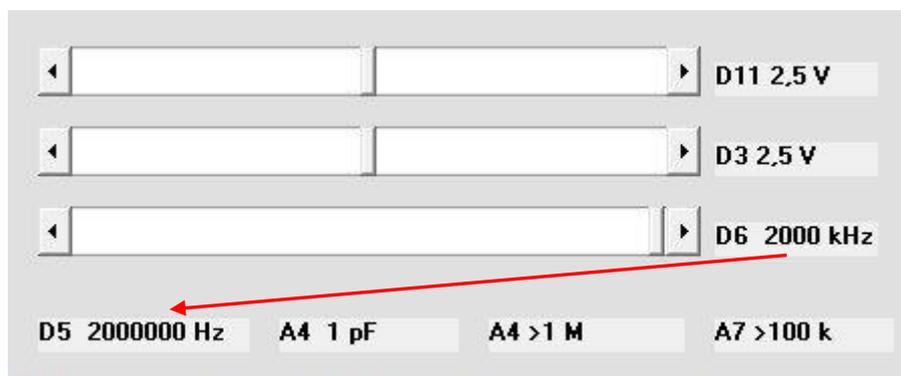
**Kapazitäts- und Widerstandsmessung:** An A4 (pF) können kleine Kapazitäten ab 1pF gemessen werden; an A4 (1M) werden Widerstände bis 1MΩ gemessen (weniger genau), an A7 sind Widerstände ab 1Ω bis 100 kΩ zu messen.
