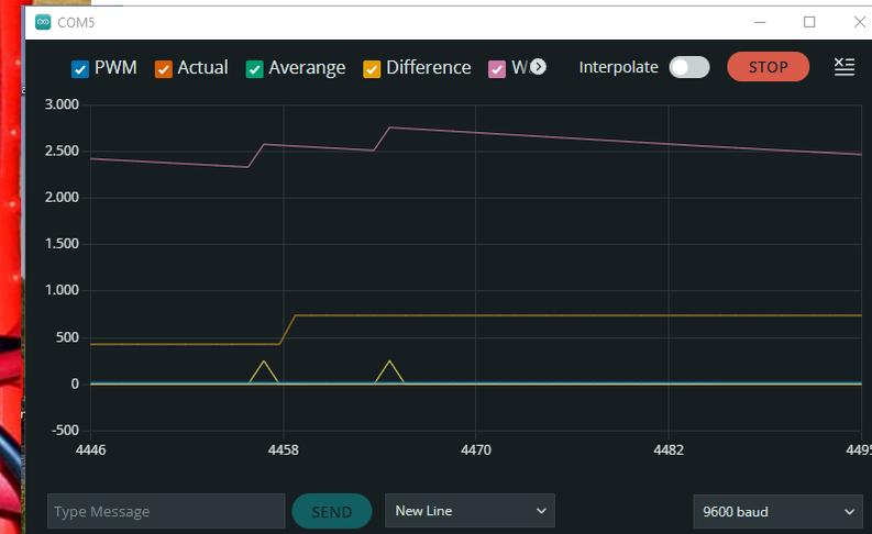
Im Serial Monitor sieht man, dass ohne ein Blitzereignis (Strikecount=0) der Warnlevel kontinuierlich geringer wird, jedem erkannten Blitz-Ereignis (Strikecount=255) wird der Warnlevel höher gesetzt wird.
