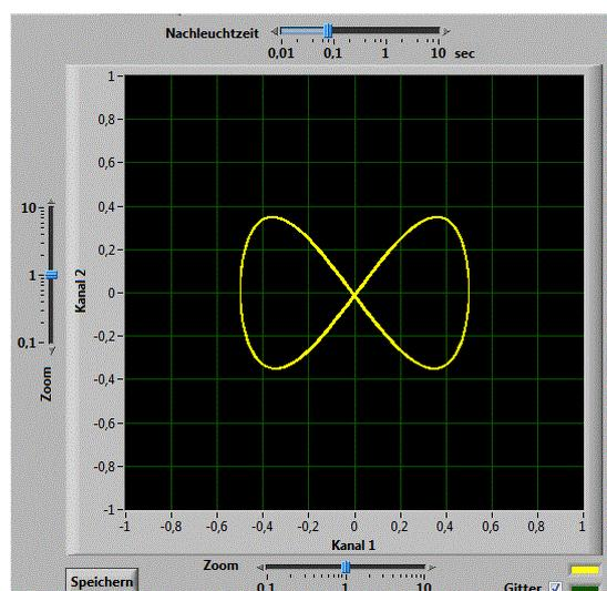
Abbildung 8: Lissajous'sche Figur für  $f_1=440\text{Hz}$ ,  $f_2=880\text{Hz}$  und einer Phase von  $0^\circ$
