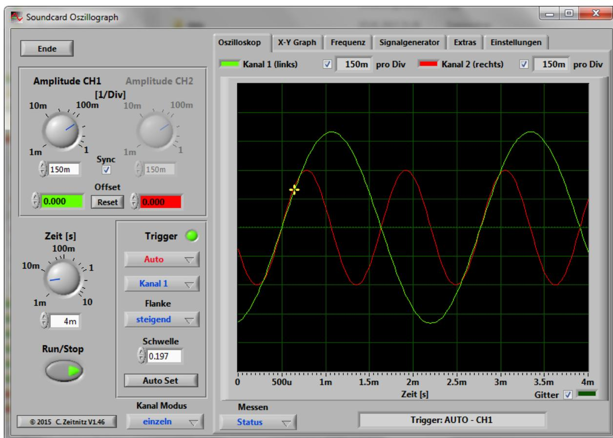
Abbildung 1: Der Soundkarten-Oszillograph
