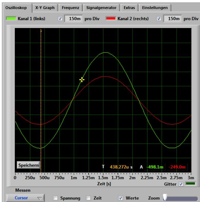
**Abbildung 6:** Zoom des Schirms bei angehaltener Datennahme (RUN/STOP aus).
