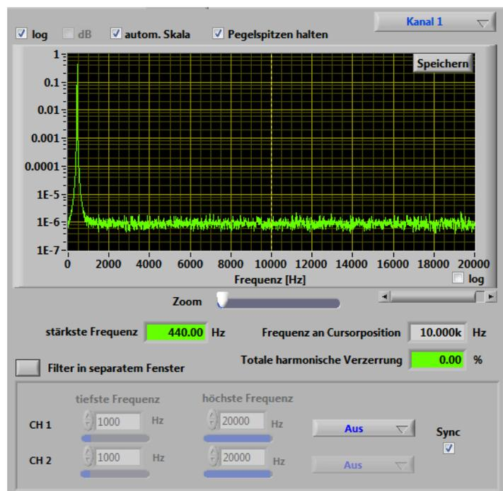
**Abbildung 9:** Frequenzanalyse eines 440Hz Signals
