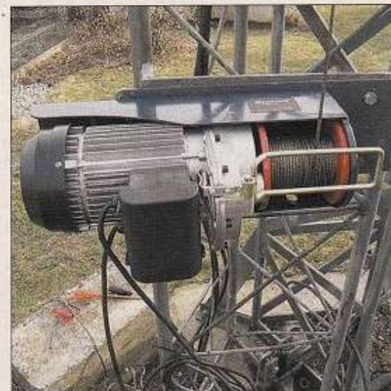
Fertig montierte Elektrowinde am *Versa-Tower*
