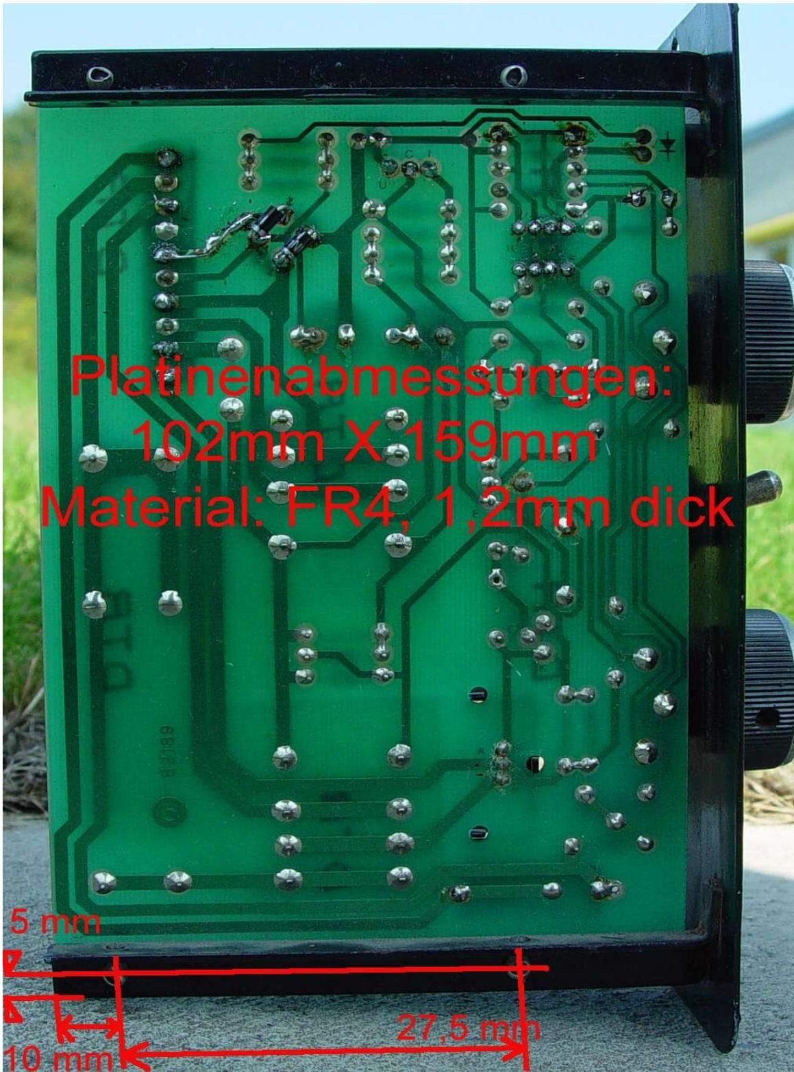
Bild 5: Abmessungen der Platine.
