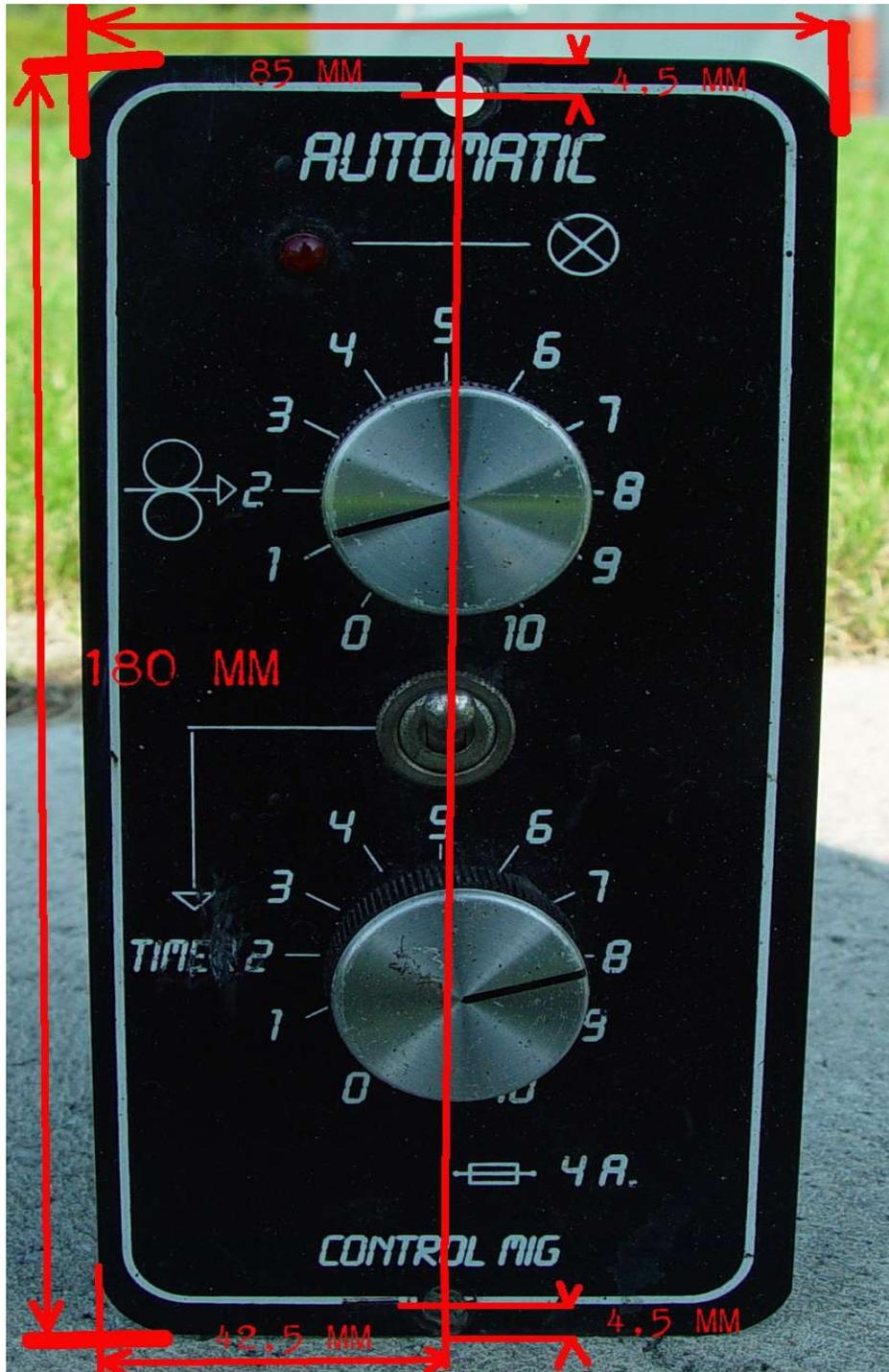
Bild 4: Frontplatte mit Bemassung.
