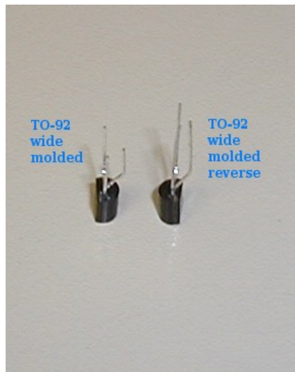
Bild 4: Beispiel für TO-92, „wide, molded“ Version. Der Transistor ist wieder ein BC327. Natürlich kann die Verkröpfung von der flachen Seite weg erfolgen (meistens), oder zu ihr hin (reverse)
