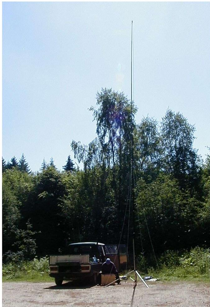
Bild 3: Mast voll ausgefahren auf 12m Höhe.
