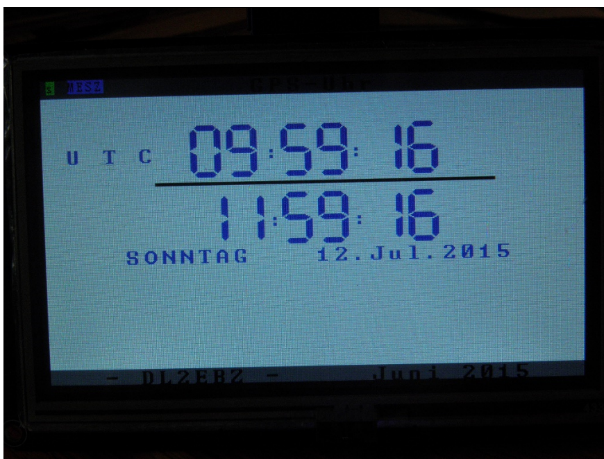
Die Anzeige auf dem 4,3“-TFT-Display (10,7cm Diagonale)
