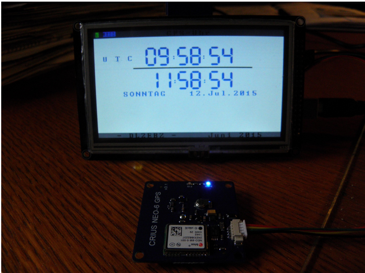
Der Prototyp mit dem GPS-Empfänger im Vordergrund
