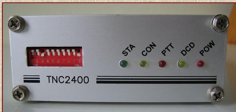
Die SYMEK Packet-Controller (TNC) können mit jedem Computer betrieben werden, der eine serielle Schnittstelle (RS232, V24) besitzt. Ideal sind IBM-kompatible (PC, AT, 386, 486 etc.), Laptops, Notebooks etc. Genau so gut lässt sich ein Atari-ST, Amiga etc.
