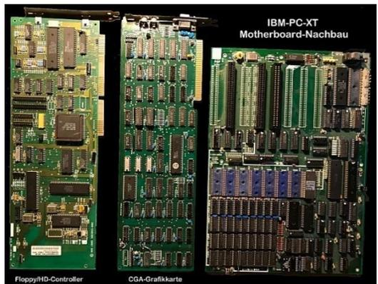
*nahm damals einen Speicherplatz von 25 kB ein. Der PC-XT-kompatible Rechner mit dem 8088 als CPU wurde dann abgelöst vom IBM-PC-AT, der mit der 16-Bit-CPU 80286 arbeitete und bereits mit dem Betriebssystem WINDOWS 3.1 laufen konnte, das sich auf MS-DOS als grafische Benutzeroberfläche aufsetzte. So mussten wieder neue Motherboards her, und die Entwicklung bis zum heutigen i9 mit WINDOWS 10 ist ja dann vielleicht auch noch bekannt.“*
