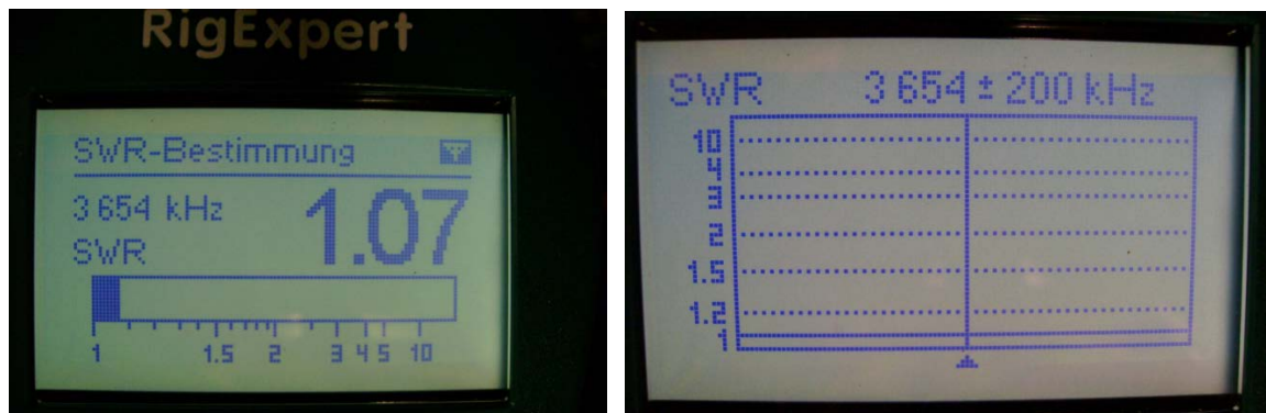
Bild 6.12 SWR bei 3654 +/- 200kHz (Ausgänge mit 100 Ohm abgeschlossen)
