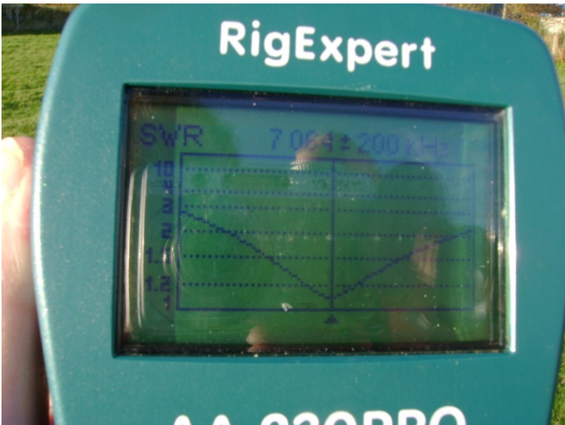
Bild 6.4 zeigt den SWR-Verlauf eines 40m-4-Square-Elements im Bereich 7064 \pm 200 KHz
