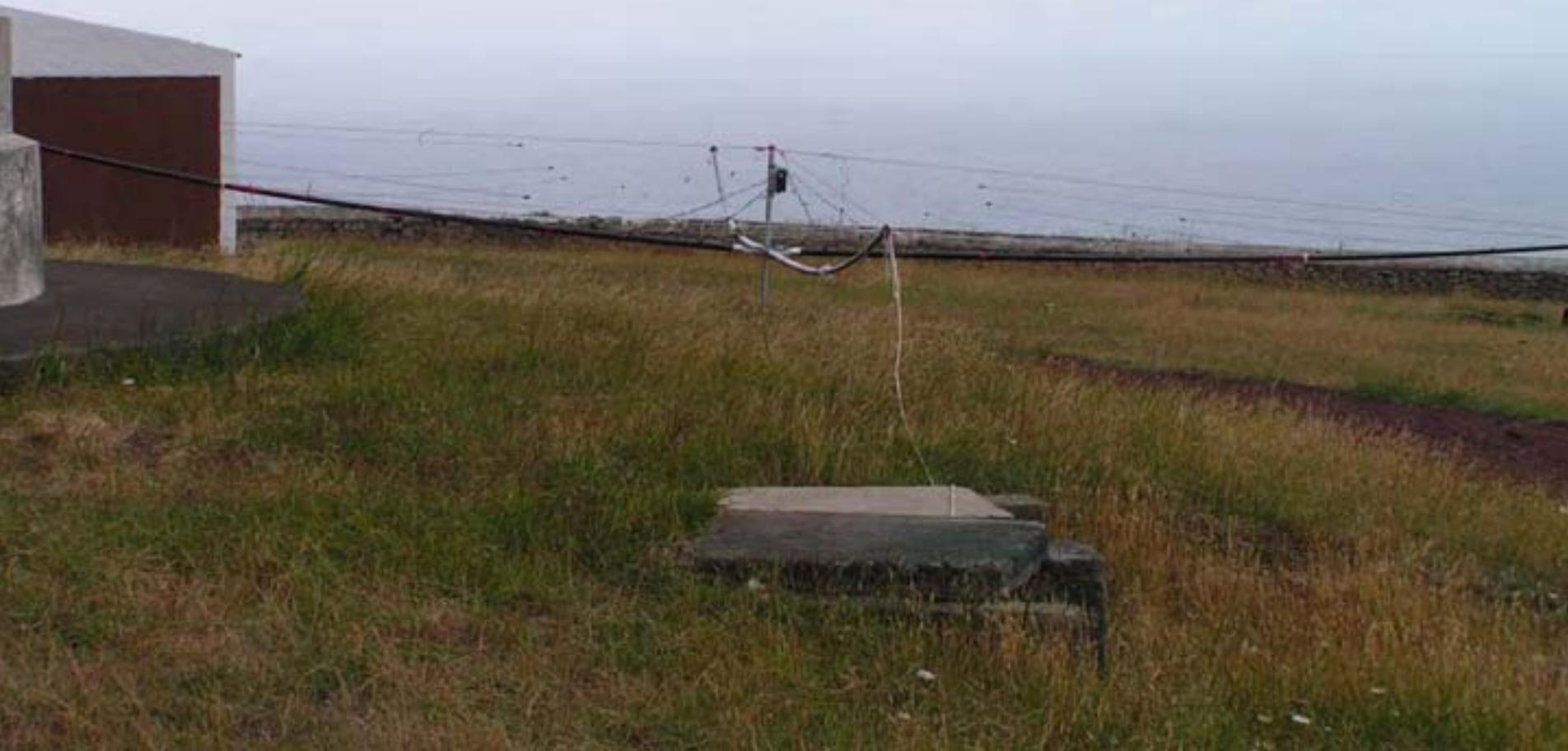
**3 Band Spider in 5m Höhe, alle Rotorkonstruktionen waren nicht funktionsfähig. Die Richtung wurde mit vorsichtshalber angebrachten Seilen eingestellt**
