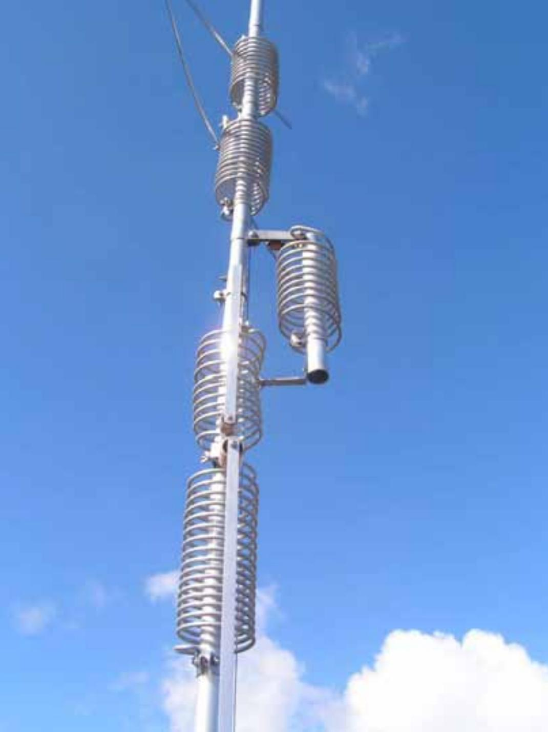
**Die Butternutt ist eine sehr beliebte Antenne für Dxpeditionen, in voller Ausbaustufe reicht sie von 160m bis 6m. Sie ist sehr leicht und kann doch einiges an Leistung Vertragen. Man muss aber bemerken, dass die Bandbreite auf 160m nur noch 6 KHz beträgt.**
