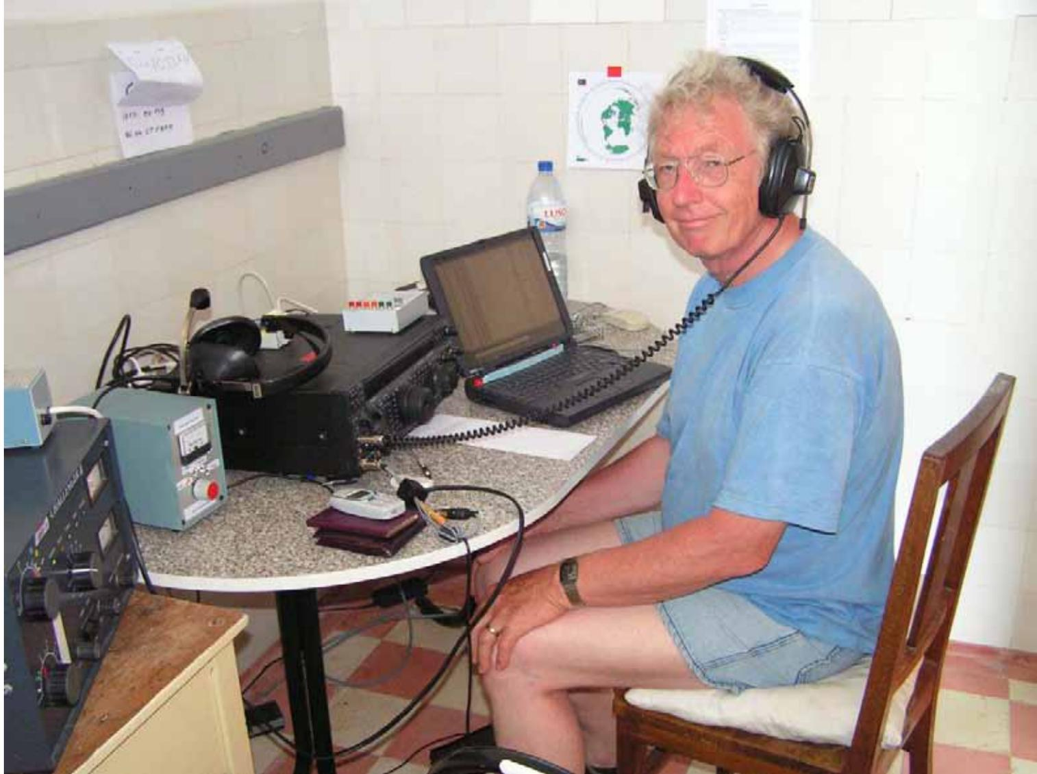
**Hermann HB9CRV (CT3FN) vor dem FT1000, links die Endstufe ungefähr 1kw, das kleine graue Gerät ist das Steuergerät für die 40m 4Square, die Hermann gebaut hat. Er war in TS7N von dem Prinzip so begeistert, dass er selbst eine 4Square für 40m und 20m gebaut hat. Bei der 20m Version hab ich ihm des Öfteren Mut machen müssen, sonst wäre die wohl nicht fertig geworden.**
