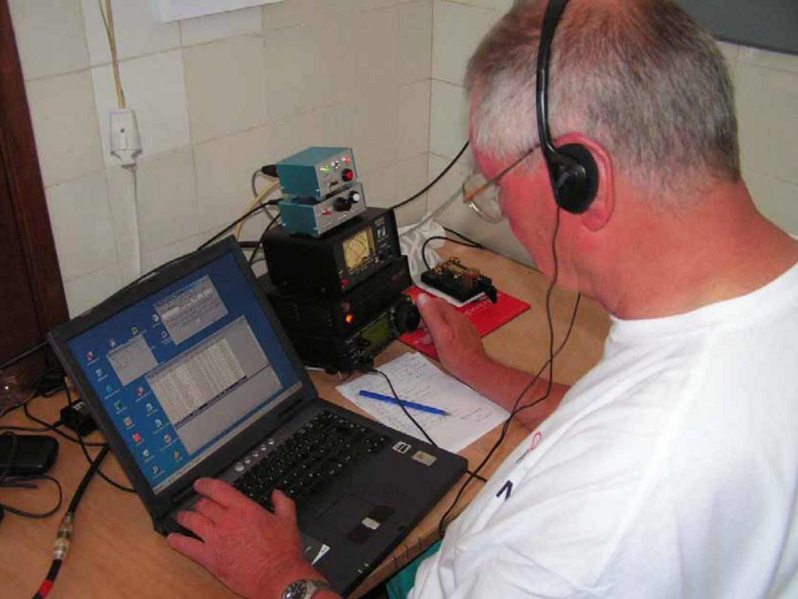
**Jürgen , DJ2VO hatte sein eigenes Equipment mit gebracht. Einen kleinen 100 Watt Transceiver, Rechner und eine 10m Vertikal (Angelrute), die mit einem am Antennenfuß angebrachten SMC Tuner auf allen Bändern zu gebrauchen war. Er war reiner CWist und der Ansicht, mehr als 100 Watt brauche ich nicht.....**
