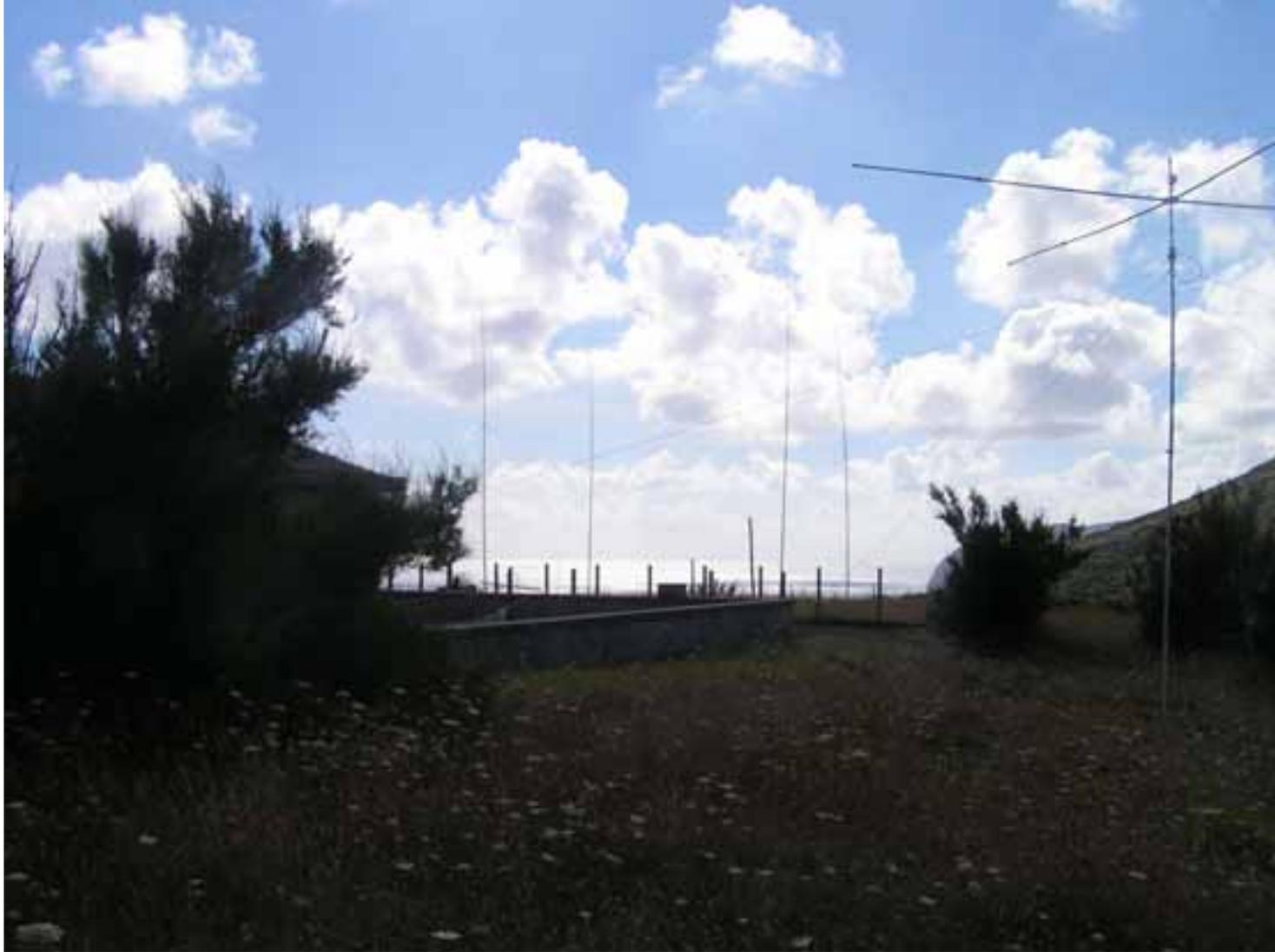
**Eine für Expeditionen sehr beliebte Antenne ist der Spiderbeam von DF4SA, das Verhältnis Leistung / Kilo ist kaum zu schlagen. Man kann ihn mit einem kleinen Fernsehantennenrotor drehen. Im Hintergrund ist eine 40m 4Square zu sehen. Die Masten sind 12m Fiberglasmasten von Spiderbeam. Im Vergleich zum Spieth Masten ist er um 2m länger und der obere Durchmesser beträgt 8mm.**
