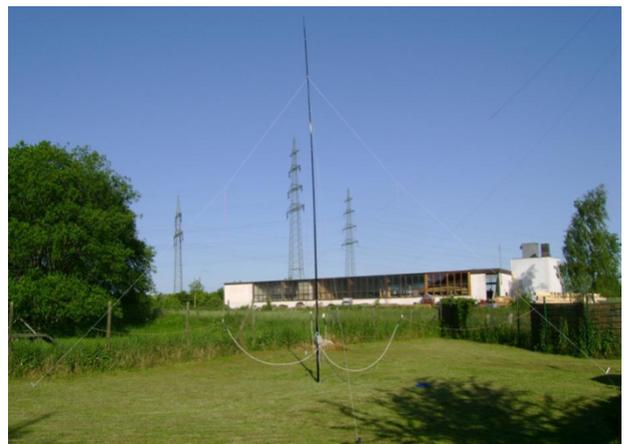
Am Nachmittag wurde dann ein verkürzter 18m Mast vor dem Check aufgebaut und ein Winkeldipol für 40m daran befestigt, das elevated in etwa 1,5m Höhe Radial wurde am Versorgungs-Container festgespannt.
