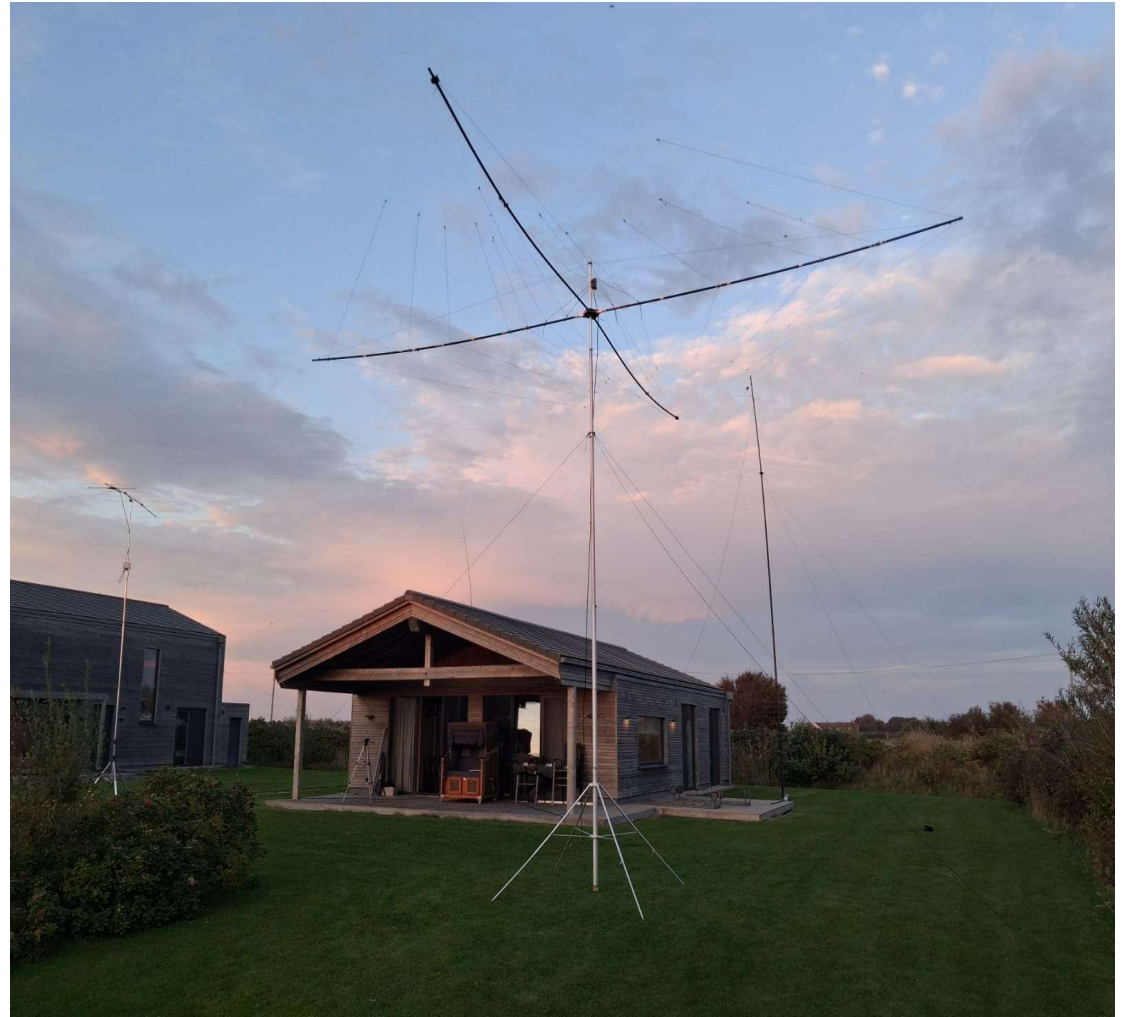
Vorne Links 9 Element 2 m, Spider Beam und Endfed im Hintergrund für FT8 und RTTY
