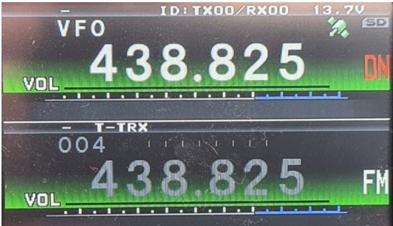
Abbildung 3: FTM-400 im reinen C4FM-Betrieb - Über dem Symbol befindet sich kein Balken
