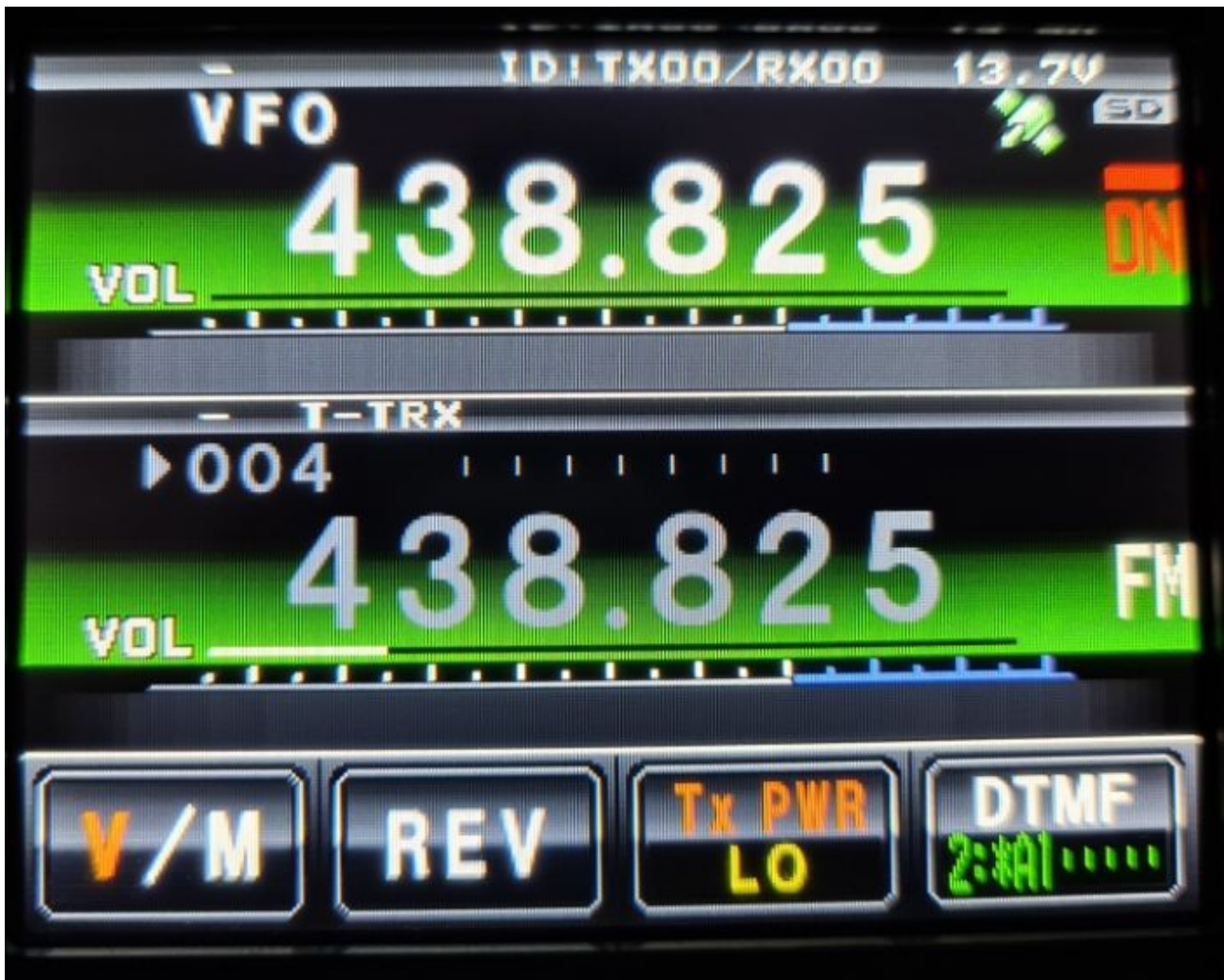
Abbildung 4: FTM-400 im AMS-Betrieb - Über dem Symbol befindet sich ein Balken
