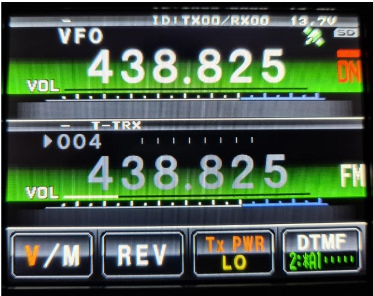
Abbildung 4: FT-400 im AMS-Betrieb - Über dem Symbol befindet sich ein Balken
