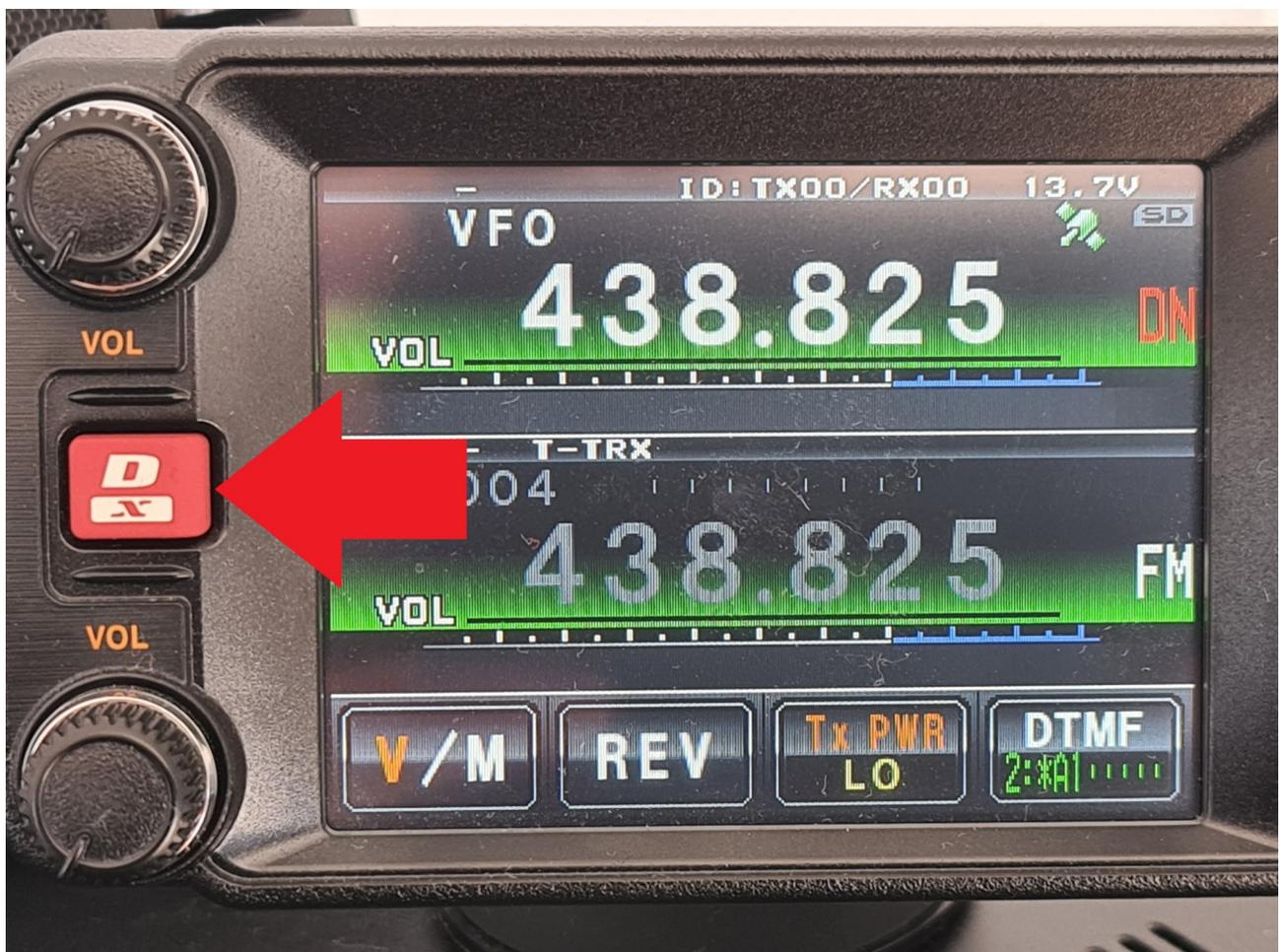
Abbildung 11: Trennen einer WIRES-X-Verbindung
