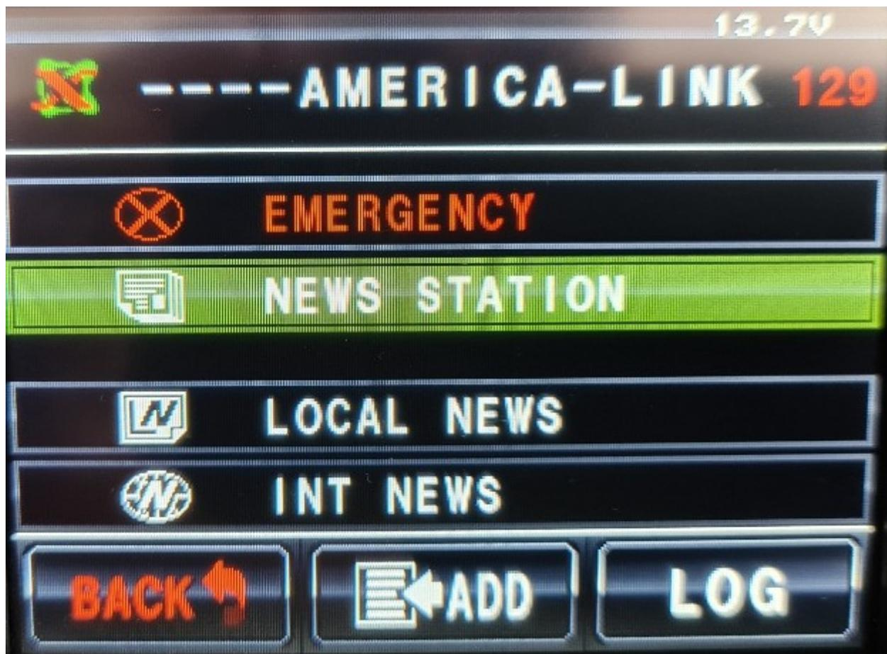
Sie sind nun zunächst im Informationsbereich des „America-Links“ gelandet. Hier können Sie ggf. Text- oder Voicenachrichten senden/empfangen, sofern diese Funktion bei der Station, mit der Sie verbunden sind, freigeschaltet ist<sup>33</sup>.
