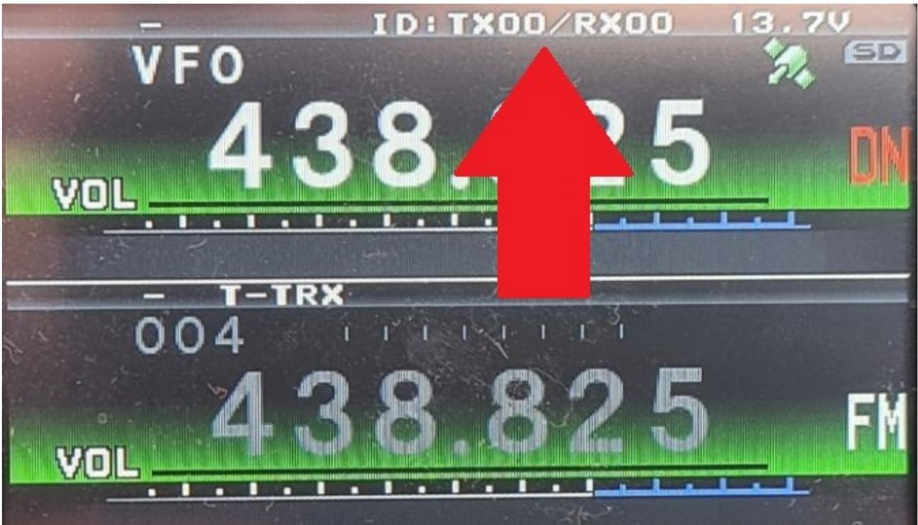
Abbildung 12: Darstellung der verwendeten DG-IDs
