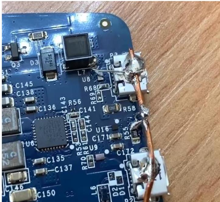
Hier sind L7 (dünner Draht), die Gehäuse der USB-Buchsen und die eine Seite von R55 mit einem GND Punkt (Masse) verbunden
