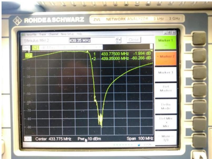
Filterkurve 2: Nahansicht Durchlass-/Sperrbereich
