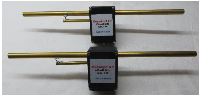
Bild 14: Messdipole für 435 MHz
