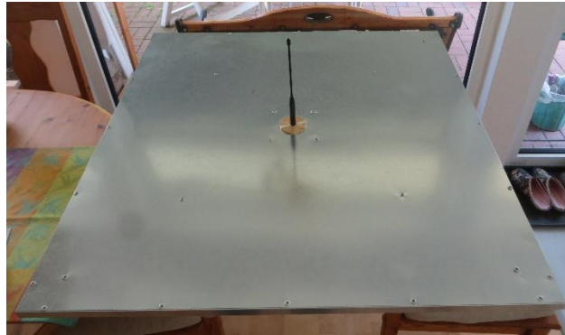
Bild 1: Antenne auf Antennenmessplatte
