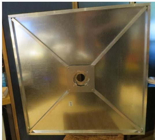
Bild 2: Unterseite der Platte mit Aussteifung
