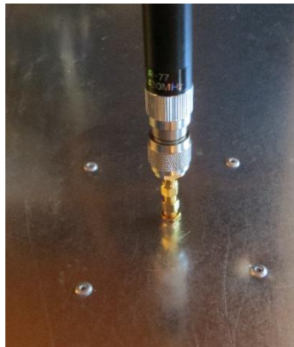
Bild 4: Antenne mit Adaptern, Antennenfuß entfernt sich von Massefläche (hier noch ohne Adapterplatte)
