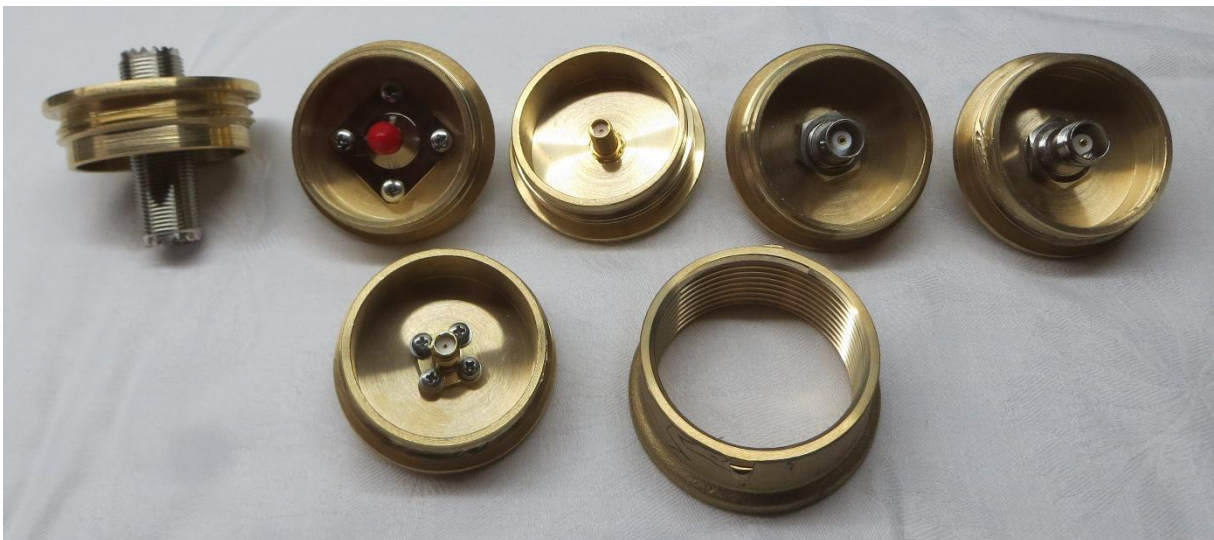
Bild 10: Adapterplatten von unten, also Messgeräte- / Messkabelanschluss
