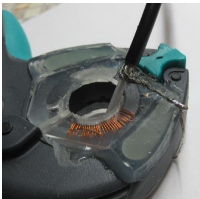
Leistungsmessung mit außen herum geführter Abschirmung
