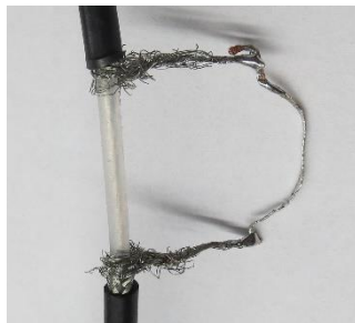
Leistungsmessung mit außen herum geführter Abschirmung
