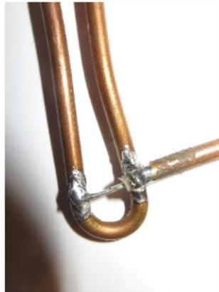
Den idealen Punkt der Koaxialkabeleinspeisung muss man selber durch probieren / messen optimieren indem man in 0,1 mm Schritten den Anschluss nach oben bzw. unten verschiebt; also zwischen 0 Ω und ca. 2500 Ω die angestrebten 50 Ω finden. Auch hier stimmen die berechneten mechanischen Maße exakt mit denen meiner aufgebauten Antenne nach Abgleich überein.
