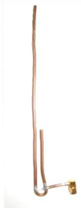
Nicht sehr schön, aber es funktioniert. Material ist 3,4 mm Kupferdraht und als Zuleitung zufällig übergebliebenes Semi-Regid Kabel mit SMA-Stecker aus einer Bastelkiste.
