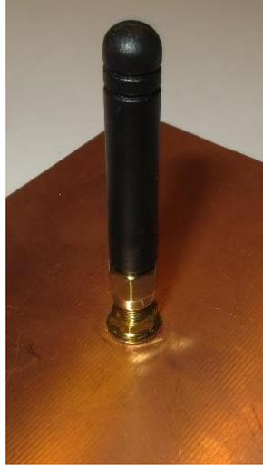
Stummelantenne (zum Gerät geliefert)
