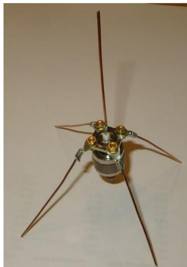
Auch hier sind die einzelnen Elemente 83mm nach Abgleich. Ansonsten Rechengang wie bei Antenne #1. Material 1,3 mm Kupferdraht und N-Flanschbuchse.
