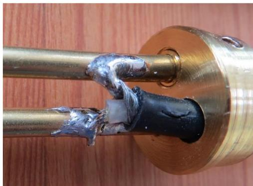
Abweichend von der Berechnung habe ich die beiden 4mm starken Messingröhrchen im Abstand von 5,05mm angeordnet, sodass diese eine 50Ω Leitung bilden. Die Berechnung erfolgte mit einem Programm von AppCad, mit dem noch viele andere Berechnungen möglich sind. Man findet diese Sammlung unter <http://www.hp.woodshot.com/>. Es muss auf dem Rechner installiert werden. Eines meiner Lieblings Tools, auch für Stripline Berechnungen für HF-Platinen etc..
