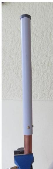
Unter „Versuche mit Antennen für LoRa auf 868 MHz“ hatte ich ja bereits von meinen Versuchen und Vergleichen verschiedener Antennen berichtet. Da es weitestgehend ja nur provisorische Aufbauten waren, habe ich jetzt eine J-Antenne in wetterfester Form aufgebaut.
