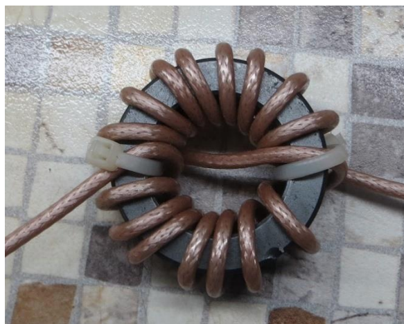
Mantelwellensperre als Strom-Balun 1:1 nach W1JT
