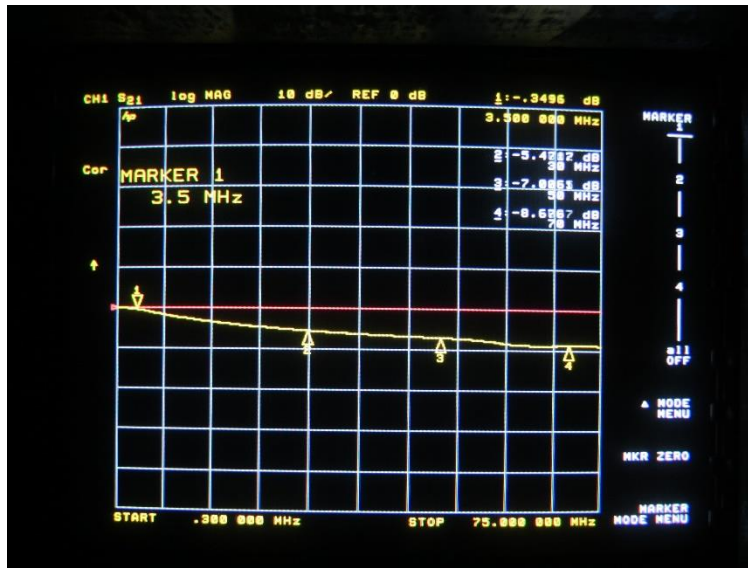
S21 mit einem Klappferrit, verwendeter Analyser: HP 8753c/85046A
